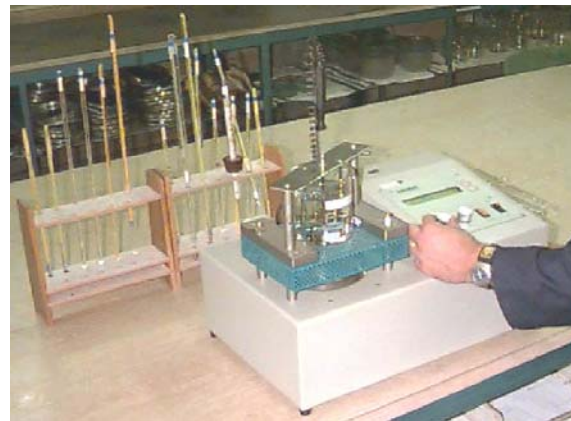
Bestämning av mjukpunkt, Kula & Ring, hos beläggningarnas bitumen.
