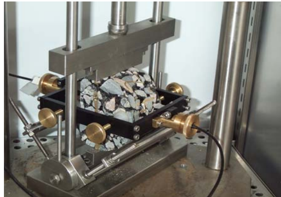
Mätning av styvhetsmodul.
