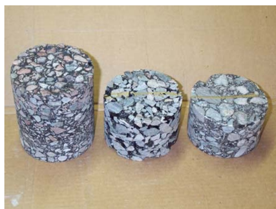
E4 vid Gävle Bro: från väster flera lager HAB 1979-1998, AEB Ö 1979 och AG 1979
